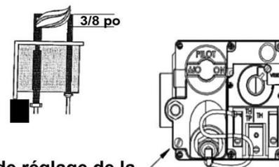
Vis de réglage de la veilleuse sous cette vis
